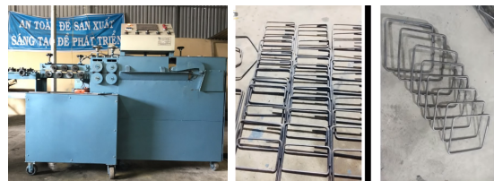
Hình 19. Máy bẻ đai do Việt Nam sản xuất.
