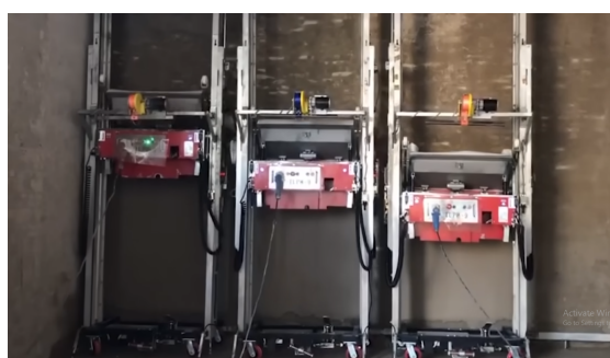
Hình 6. Máy trát tường TUPO.
